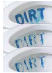
Descarga que limpia sin eliminar la totalidad de residuos.
